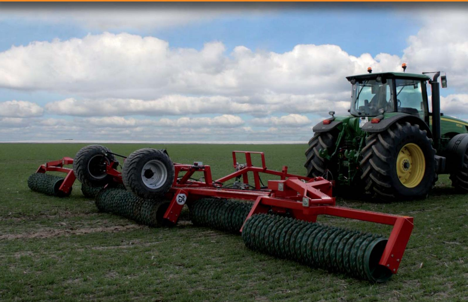
Die Actiroll HD und HDC in Arbeitsbreiten von 9,50 bis 12,30 m sind mit dem hydraulischen Gewichtsausgleich Contura ausgestattet: das Gewicht vom Rahmen wird gleichmäßig über zwei Hydraulikzylinder auf die Seitenflügel übertragen.
