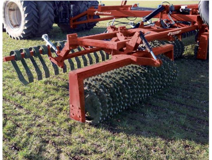
Ausgestattet mit einem Crossboard ist die Actiroll HDC ein universelles Gerät zur Saatbettbereitung. Da jede Sektion mittig aufgehängt ist, folgt die Walze allen Bodenkonturen und gewährleistet somit eine gleichmäßige Einebnung und Rückverfestigung.
